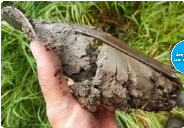
Échantillon de sol récolté à l'aide d'une tarière afin de caractériser le sol d'un milieu humide.
